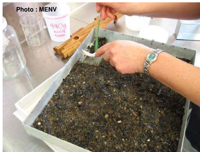
Figure 7 : Fractionnement avec la boîte « Caton »
